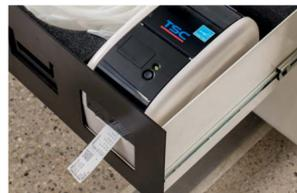
„Ongoing job report“ in der Maschine, QR-Code und die mobile AGRU App dokumentieren alle Schweißparameter wie Temperatur, Fügedruck und Zeit.
