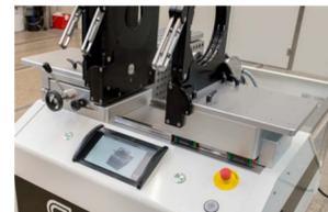
Die längeren äußeren Tische für die Hauptspannbacken erleichtern das Einspannen großer Teile, wie z. B. Membranventile.
