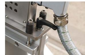
Das Heizelement lässt sich für den sicheren Transport mit einem Klemmhebel fest arretieren.
