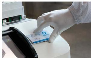
RFID Datenerfassung für Schweißeridentifikation und Systemzugang in Verbindung mit den vorprogrammierten Schweißabläufen gewähren einen sehr sicheren und automatisierten Schweißprozess.
