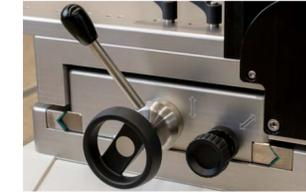
Parallelgeführte Höhen- und Seitenverstellung der Spannbacken für exakte spannungsfreie Ausrichtung der Schweißzone mit geringstem Rohrversatz.
