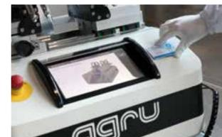
RFID Datenerfassung für Schweißidentifikation und Systemzugang in Verbindung mit den vorprogrammierten Schweißabläufen gewähren einen sehr sicheren und automatisierten Schweißprozess.
