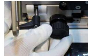
Mechanische Höhen- und Seitenverstellung der Spannbacken für exakte spannungsfreie Ausrichtung der Schweißzone mit geringstem Rohrversatz.
