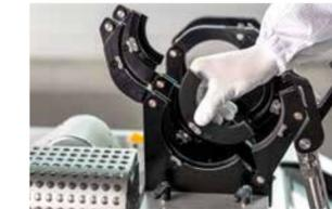
Dank magnetisch fixierter Spanneinsätze erfolgt der Wechsel auf andere Dimensionen partikelfrei, schnell und einfach ohne Werkzeug.
