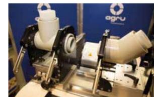
Das neue AGRU Doppelrohrsystem Poly-Flo in PE und PP lässt sich nun rasch und in perfekter Qualität verschweißen.
