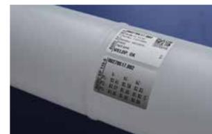
„Ongoing job report“ in der Maschine, QR-Code und mobile AGRU App dokumentieren alle Schweißparameter wie Temperatur, Fügedruck und Zeit.
