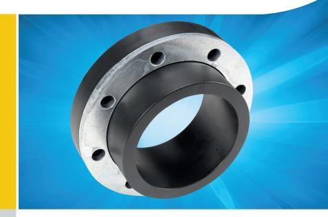
Der AGRU PE 100-RC Sonderflansch ist ideal für Verbindungen von PE Rohrsystemen mit z.B. metallischen Armaturen. Die spezielle Geometrie erlaubt einen Nennweiten-gerechten Anschluss, womit die Armatur um eine Dimension kleiner ausgelegt werden kann und so Kosten reduziert werden. Der Totraum zwischen Sonderflansch und Armatur wird verkleinert, somit verbessern sich die Fließeigenschaften und Ablagerungen werden wesentlich reduziert.
